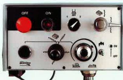
ワンタッチレバースイッチによる前後左右送り付き。
