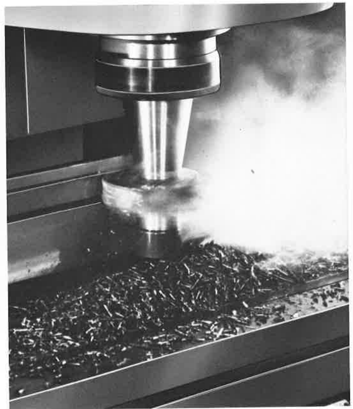
材 質.....S45C 冷却液使用 工 具...SKH a 100φ×25.4mmサイドカッタ(18刃チドリ) 主軸回転数.....110rpm 切 込 み.....15mm テーブル送り速度.....80mm/min
