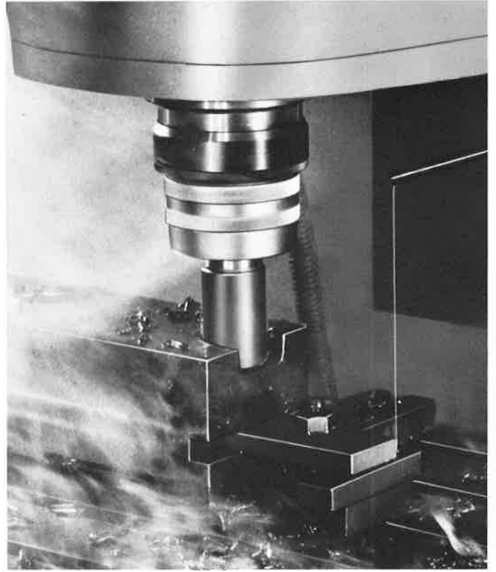
材 質.....S45C 冷却液使用 工 具.....STi 25 50φ×2枚刃ジャンボエンドミル 主軸回転数.....530 rpm 切 込 み.....20mm テーブルの送り速度.....80mm/min
