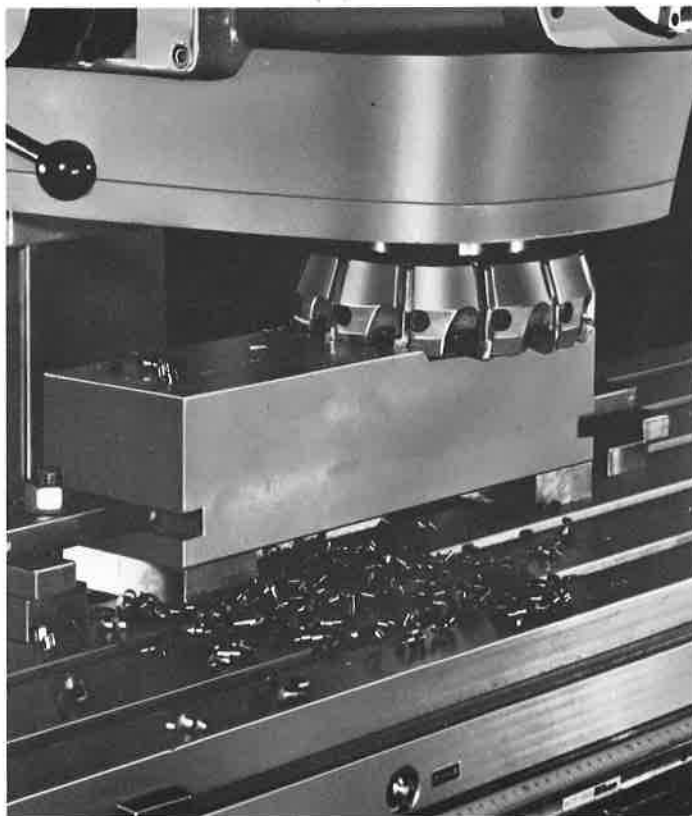
材 質.....S45C 工 具.....STi 25E 200φ刃12枚刃フルバックカッタ 主軸回転数.....140 rpm 加工巾と切込み.....120×8mm テーブルの送り速度.....115mm/min
