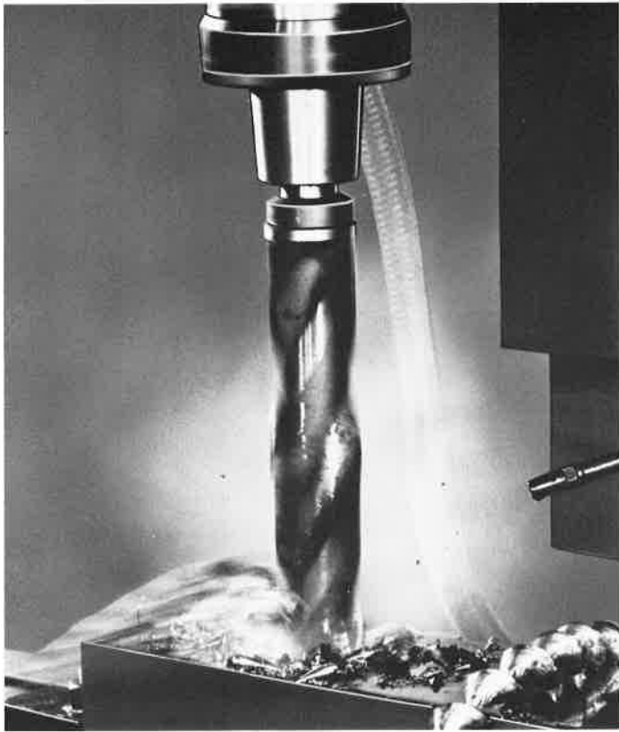
材 質.....S45C 冷却液使用 工 具.....SKH 9 50φドリル 主軸回転数.....140 rpm 下 穴 径.....0 主軸頭の送り速度.....0.2 mm/rev
