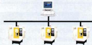
ネットワークに接続したパソコンで集中管理パッケージ **DRILL MONITOR i** を使用すると、ロボドリルのプログラムを管理したり稼動状況をモニタすることができます。
