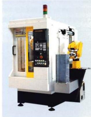
LR Mate 100iB付きミニ加工セル
