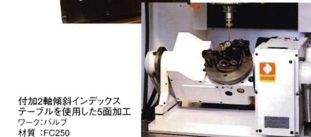
付加2軸傾斜インデックステーブルを使用した5面加工
